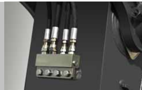
Tubería de acoplador rápido
