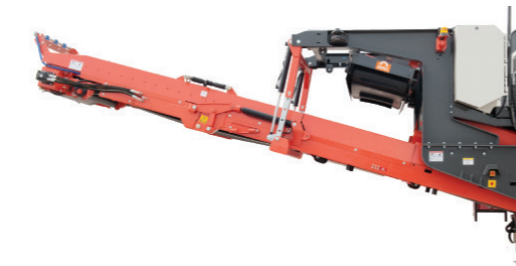
Elevación y descenso hidráulicos en el transportador principal
